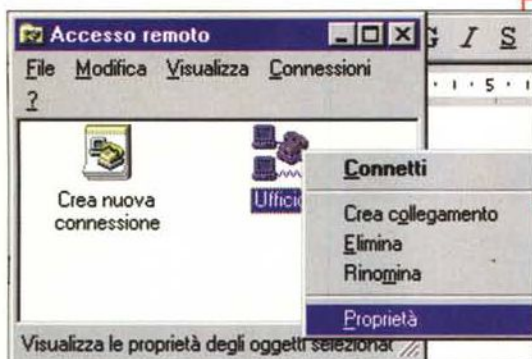
Figura 4 - Creata la nuova connessione è necessario configurarla. Per procedere con la sua configurazione dobbiamo cliccare con il tasto destro del mouse sulla nuova icona che, nel frattempo, è comparsa all'interno della cartella di Accesso Remoto e successivamente selezionare la riga proprietà.
